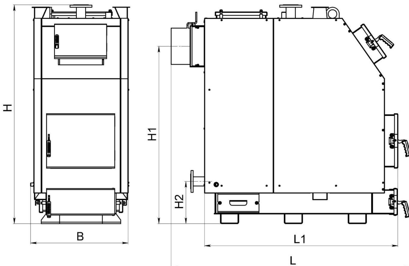
Рисунок 3.1 – Позначення габаритів котла типу КТП
