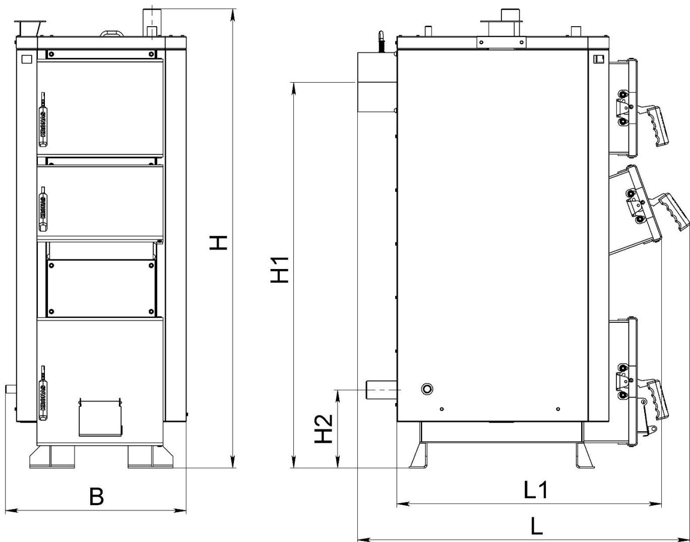
Рисунок 3.1 – Позначення габаритів котла типу КТК
